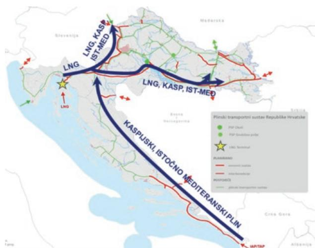
Strateški projekti kojima se povećava diversifikacija opskrbe i učinkovitost transportnog sustava su plinovodni sustav za otpremu plina iz terminala za UPP, Jonsko-jadranski plinovod te sustav plinovoda Lučko – Sotla i Slobodnica – Sotin.
